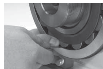
После монтажа проводится проверка радиального внутреннего зазора ненагруженного ролика.
